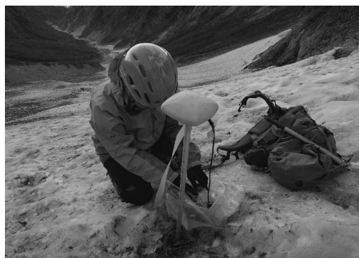
写真4 GPSによる氷体の流動観測
