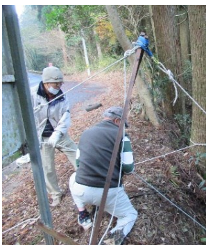
ゴミの引き上げに支柱、滑車、ロープを使う方法が大活躍！
